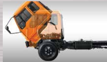
Kabin Jungkit Mudah dalam pemeriksaan dan perawatan mesin.
