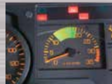
Tachometer Mempermudah penyesuaian putaran mesin dengan kecepatan kendaraan, agar irit BBM.
