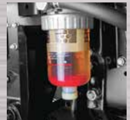
Transparent Water Separator Mempermudah dalam melakukan pemeriksaan kondisi bahan bakar dan air.
